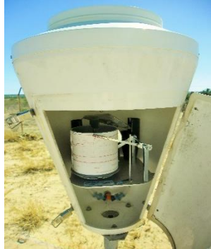
Figure 10 : Pluviographe (source : auteur)
