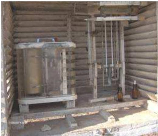
Photo N°1 : Evaporomètre piche
