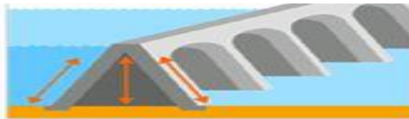
Figure 3: Barrage à contreforts ( www.swissdams.ch/fr/les-barrages/les-differents-types-de-barrages )
