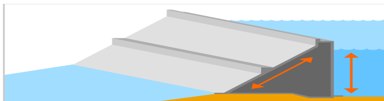
Figure 1: Barrage à poids ( www.swissdams.ch/fr/les-barrages/les-differents-types-de-barrages )
